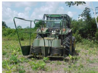
**Figura 01.** Fresadora AHWI 600 (à esquerda) e Tritocap (à direita) ambos acoplados a um trator.
