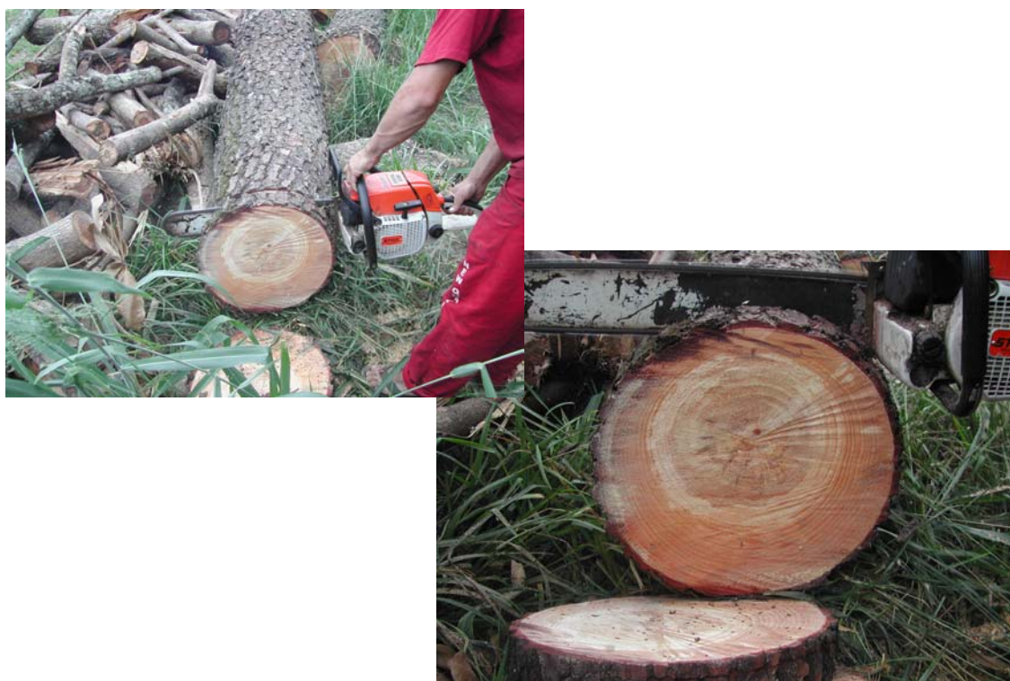
Figura 2. Detalhes do corte dos discos.
