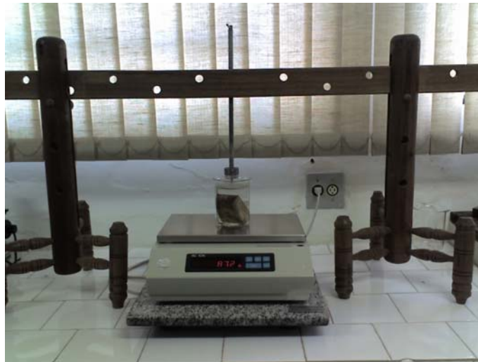
Figura 5. Determinação do volume do corpo-de-prova ao longo da determinação da densidade básica.
