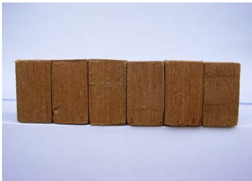
Figura 7. Corpos-de-prova de cedro, submetidos ao ataque de C. gestroi por 45 dias.
