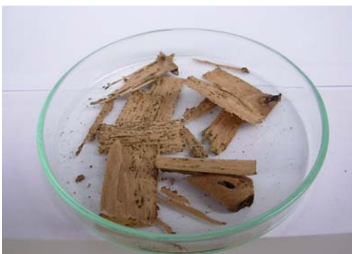
Figura 1. Corpos-de-prova de eucalipto, submetidos ao ataque de C. gestroi por 45 dias.
