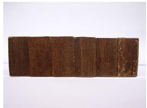
Figura 8. Corpos-de-prova de maçaramduba, submetidos ao ataque de C. gestroi por 45 dias.
