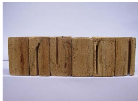
Figura 4. Corpos-de-prova de cinamomo, submetidos ao ataque de C. gestroi por 45 dias.
