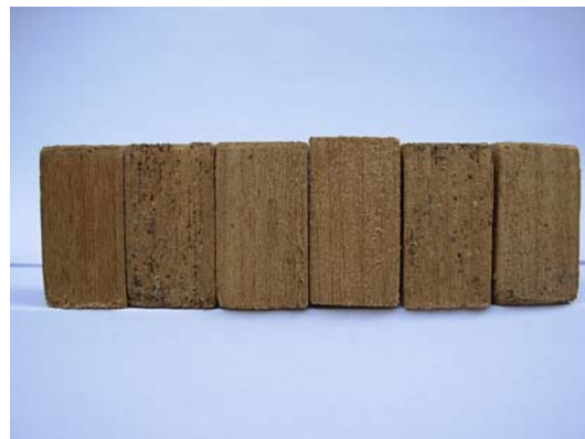
Figura 9. Corpos-de-prova de freijó, submetidos ao ataque de C. gestroi por 45 dias.
