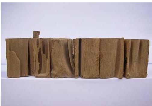
Figura 3. Corpos-de-prova de lanterna, submetidos ao ataque de C. gestroi por 45 dias.
