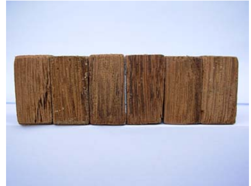
Figura 6. Corpos-de-prova de angelim, submetidos ao ataque de C. gestroi por 45 dias.
