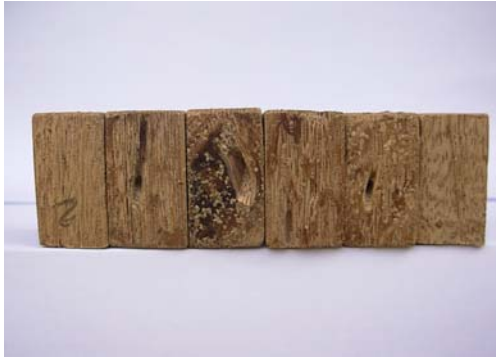
Figura 5. Corpos-de-prova de ingá, submetidos ao ataque de C. gestroi por 45 dias.
