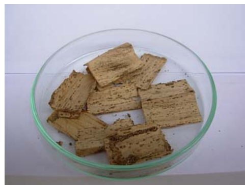
Figura 2. Corpos-de-prova de pinus, submetidos ao ataque de C. gestroi por 45 dias.
