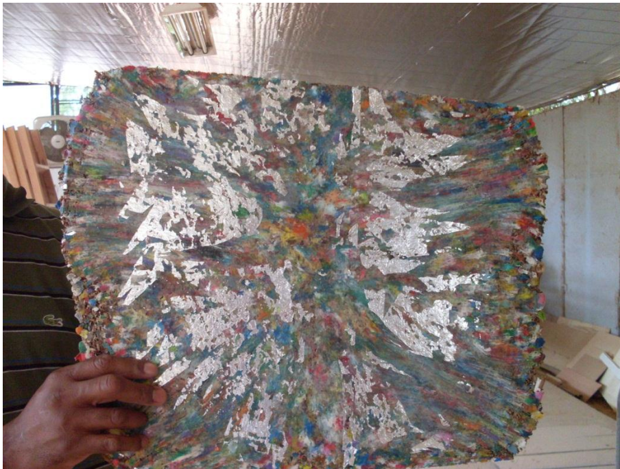
Figura 19: Alumínio no painel CMP
