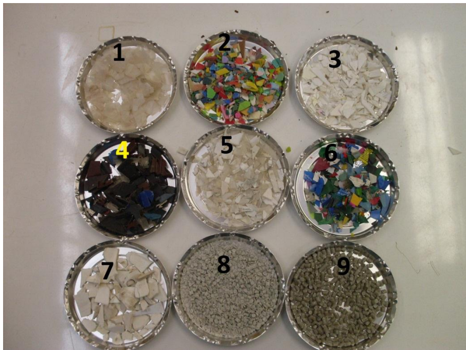
Figura 2: Termoplásticos testados no pré-teste na temperatura de 200°C, sendo 1= PP puro, 2=PP colorido, 3=PP branco, 4= PP preto, 5= PEAD branco, 6= PEAD colorido, 7= PP cadeira, 8= PEAD em pellets, 9= PEBD em pellets.
