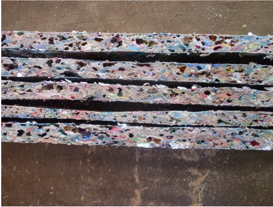
Figura 18: Defeitos dos painéis CMP.
