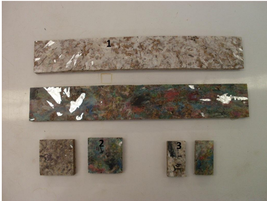
Figura 5: Corpos de prova (cp) utilizados nos ensaios mecânicos, sendo 1= cp utilizado no ensaio de flexão estática, 2= cp utilizado nos ensaios de dureza janka, inchamento em espessura, densidade aparente e ligação interna e 3= cp utilizado no ensaio de compressão.
