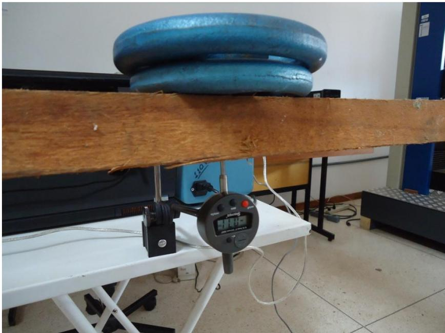
Figura 4 – Relógio comparador em uso durante a avaliação pelo método estático.
