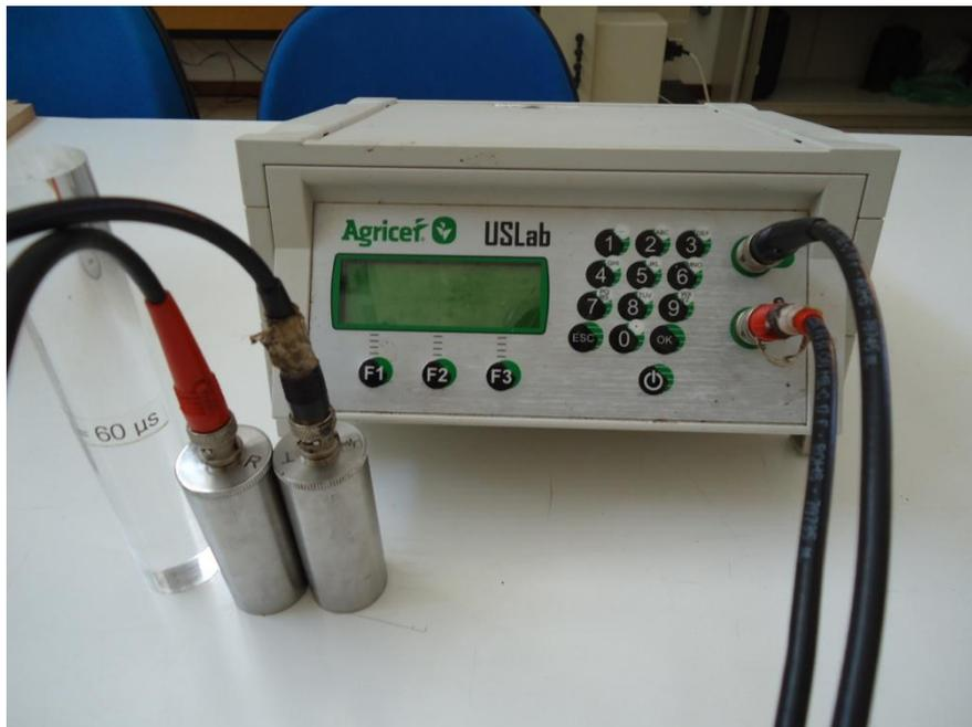
Figura 3 – Aparelho de ultrassom Uslab.
