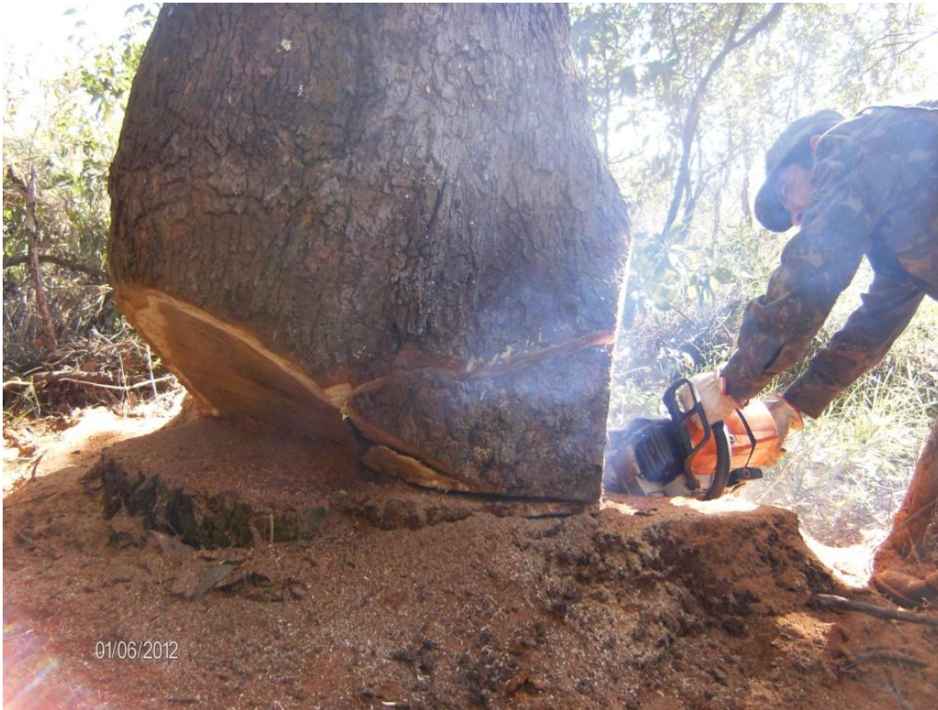
Figura 9 – Corte de árvore selecionada para a cubagem rigorosa utilizando-se uma motosserra Stihl 381 com potência de 5.3 Cv e peso de 6kg.
