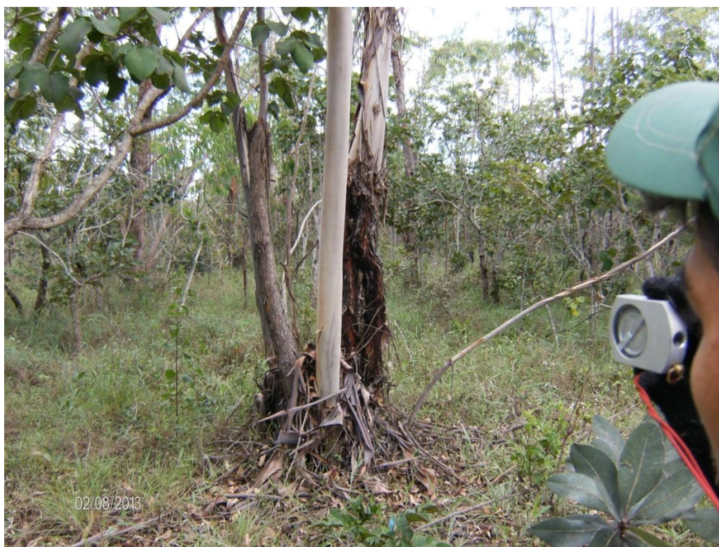
Figura 8 – Hipsômetro Sunnto, utilizado para mensuração da altura das árvores.
