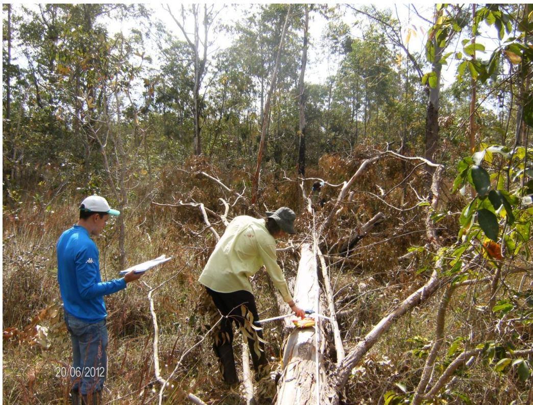
Figura 11 – Cubagem rigorosa das árvores pelo método de Hohenadl 10 seções, mensurando-se os diâmetros das seções com uma Suta Diamétrica de 80cm.
