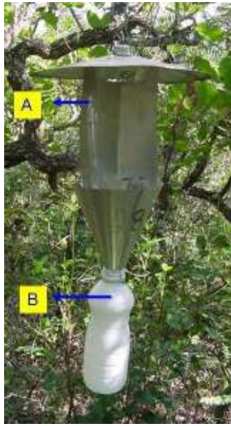
FIGURA 3. Armadilha etanólica adaptada do modelo escolitídeo-Curitiba. A: porta-isca; B: recipiente coletor.
