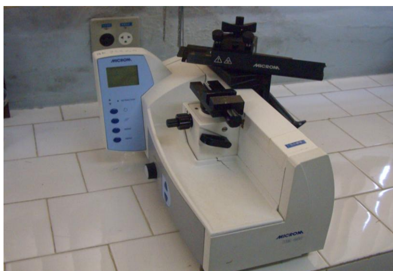
Figura 6. Micrótopo de deslize MICRON HM 450 utilizado para obtenção dos cortes histológicos (Laboratório de Anatomia e Qualidade da Madeira, DPF/IF/UFRRJ).
