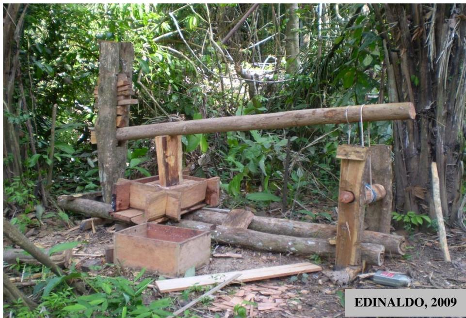
**Figura 6** - Prensa rústica utilizada na fabricação de blocos de CVP, Lábrea/AM, 2009.
