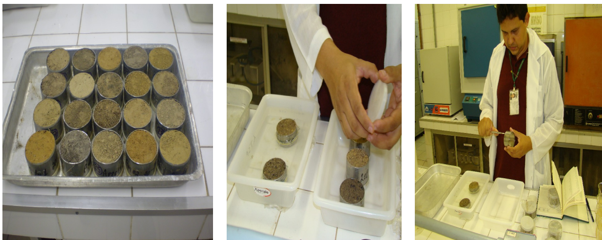
Figura 4. Amostra de solo em cilindro volumétrico para determinação da densidade do solo (A); preparação das amostras para determinação da densidade (B), aferição do diâmetro e altura com o paquímetro (C).
