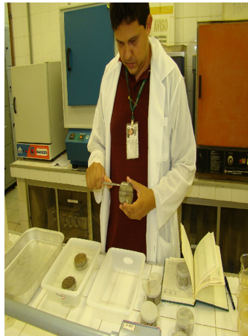
Figura 7. Abertura de perfis de solo (A), retirada de amostras indeformadas (B), classificação de solos (C) e aferição de anéis volumétricos (D).
