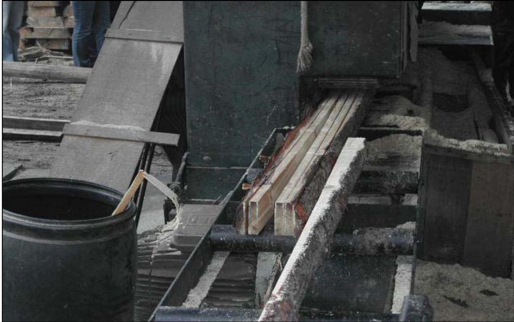
Figura 12. Produção de tábuas pela serra circular múltipla da linha II da serraria da Empresa LPZ Artefatos de Madeira LTDA.
