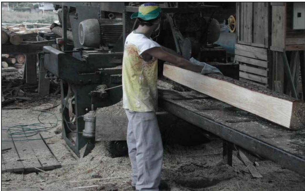
Figura 11. Recebimento do semibloco produzido na serra circular quádrupla para abastecimento da serra circular múltipla da linha II da serraria da Empresa LPZ Artefatos de Madeira LTDA.
