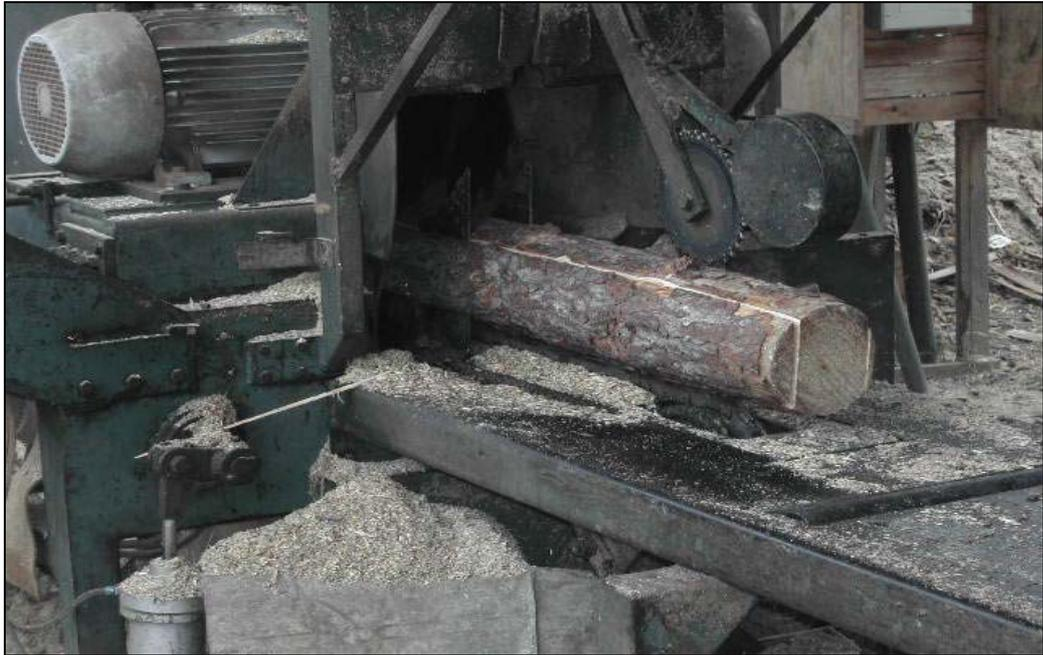
Figura 10. Produção de um semibloco e duas costaneiras pela serra circular quádrupla da linha II da serraria da Empresa LPZ Artefatos de Madeira LTDA.
