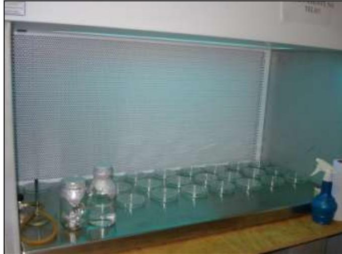
**Figura 04:** Câmara de fluxo laminar estéril com placas petri distribuídas.
