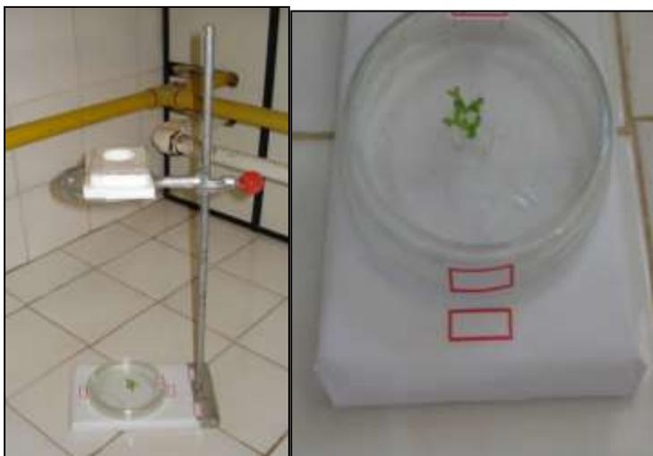
**Figura 15:** Suporte para fotos perpendiculares a uma altura constante.
