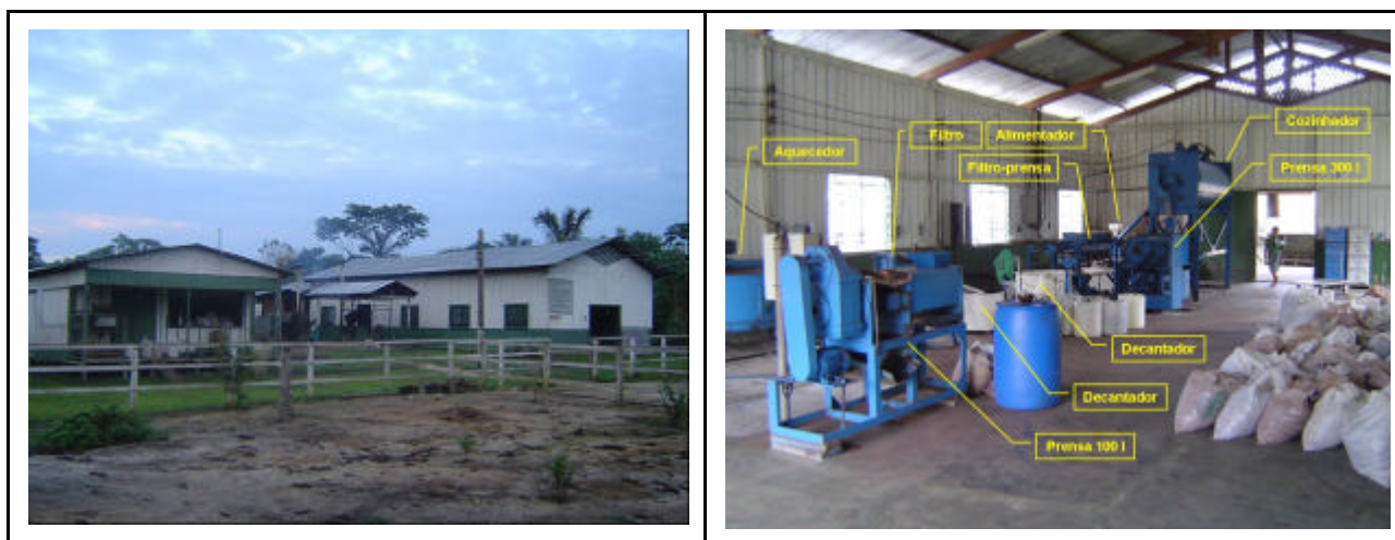
Figura 36 – Vista geral da cooperativa – galpão de sementes à esq., fornhalhas ao centro e fábrica à dir. (esq.) e interior da fábrica (dir.)
