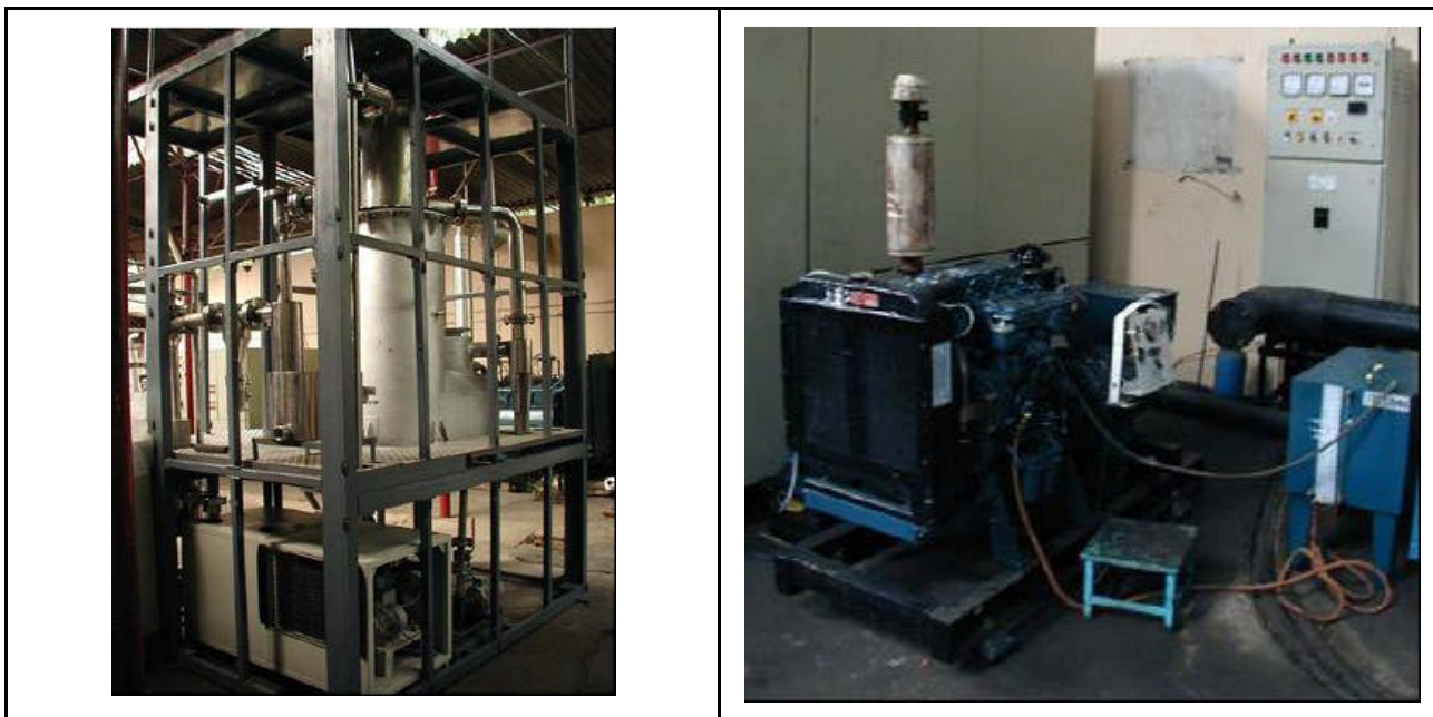
Figura 22 – Gaseificador do IISc (esq.) e motor Kirloscar (dir.) Fonte: Cenbio (2003), Relatório no âmbito do Convênio Finep/CT-Energ 23.01.0695.00.
