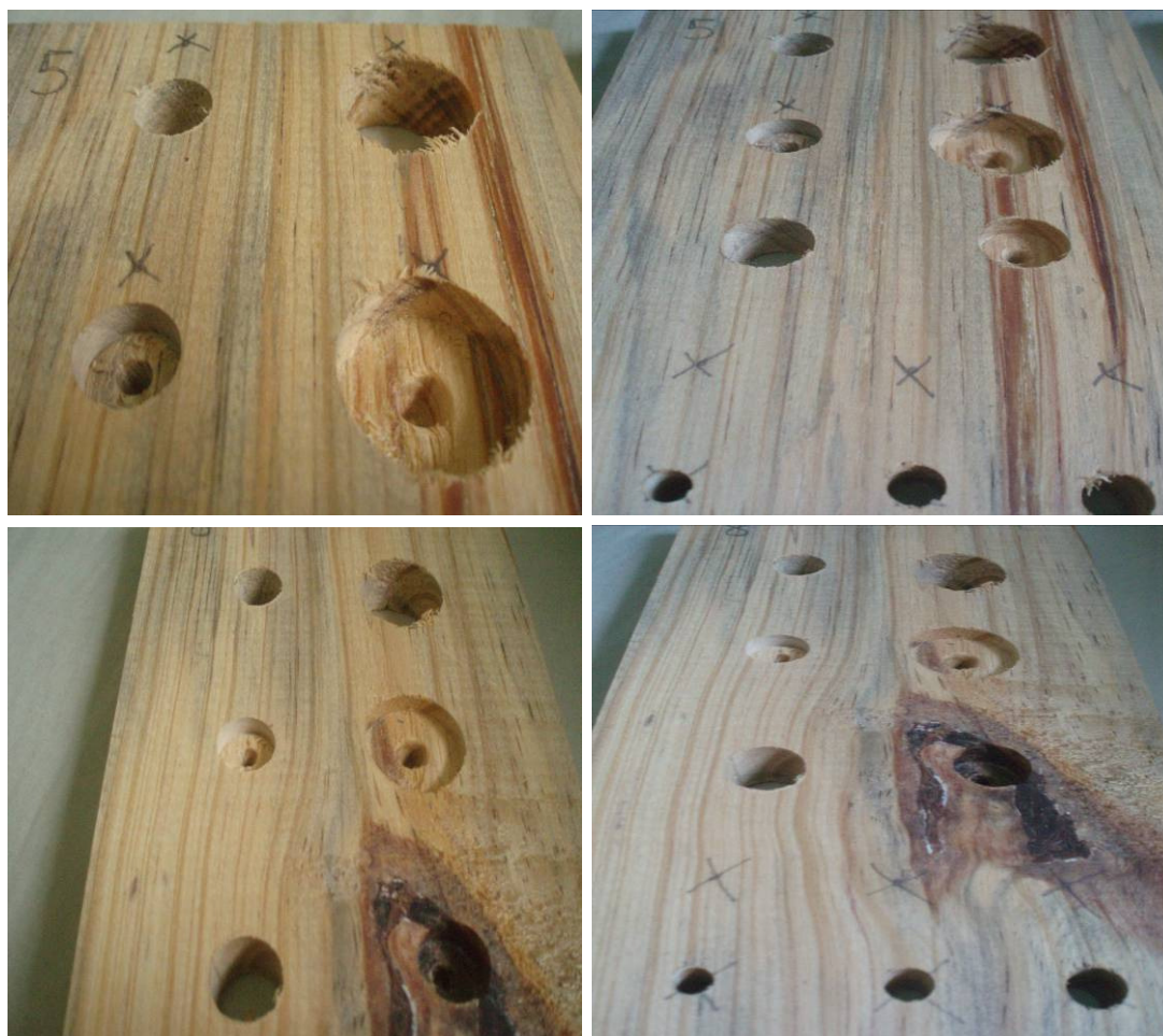
Figura 6. Detalhes dos testes de furação em madeira de Pinus (testemunha).
