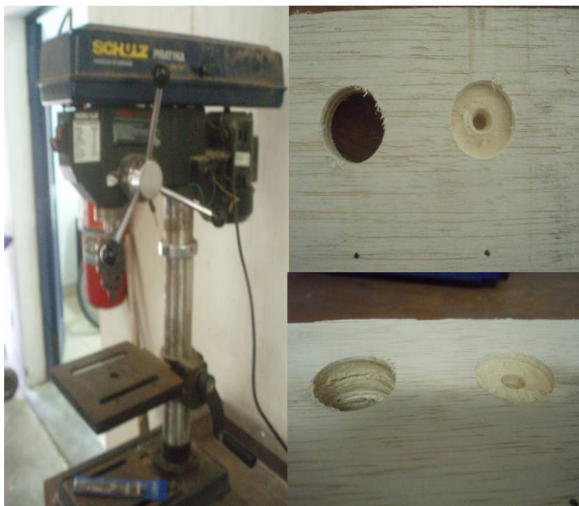
Figura 3. Detalhes do ensaio de furação nos painéis compensados.
