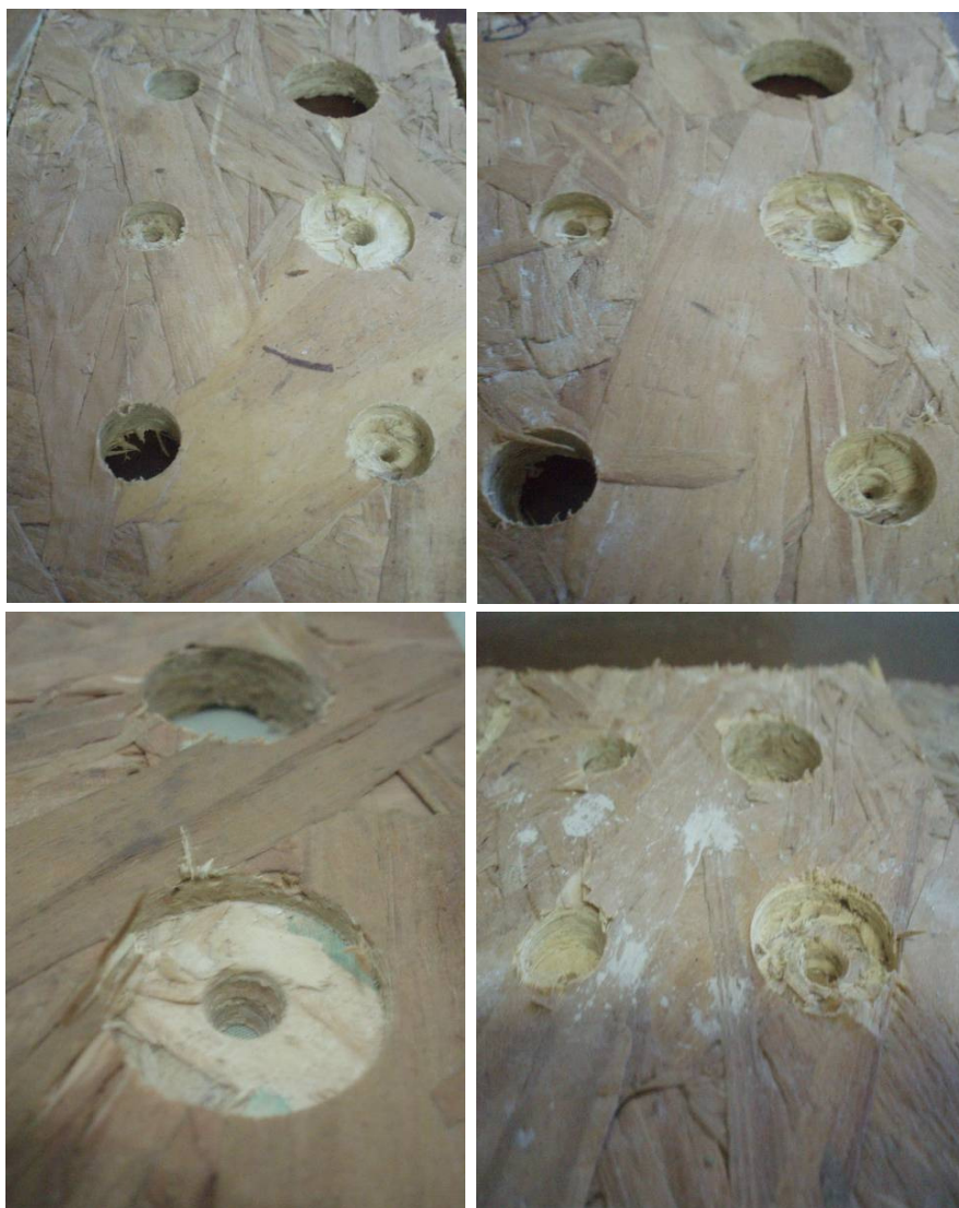
Figura 4. Detalhes dos testes de furação nos painéis OSB.
