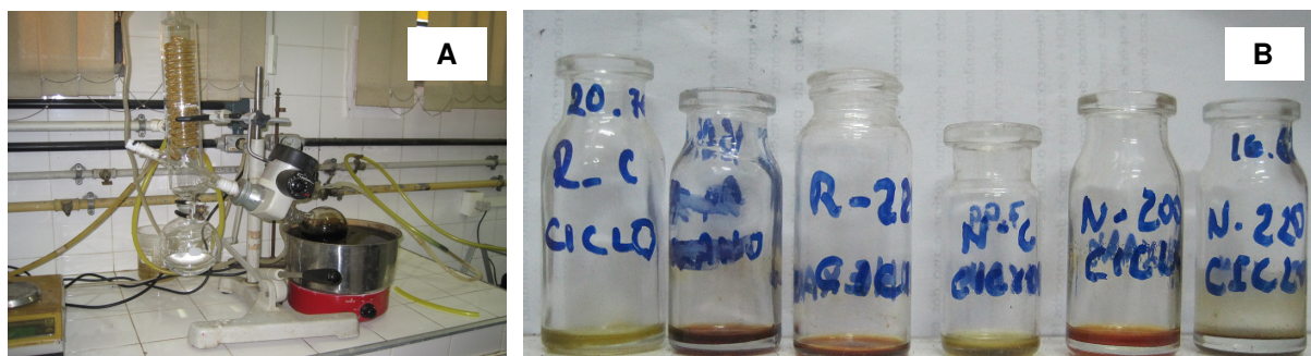
Figura 5. (A) Aparelho rotavapor utilizado para retirar excesso de solvente. (B) Extrativos obtidos após retirada do excesso do solvente para a madeira de compressão não termorretificada e termorretificadas à 200 e 220°C e para a madeira normal não termorretificada e termorretificadas à 200 e 220°C, respectivamente.
