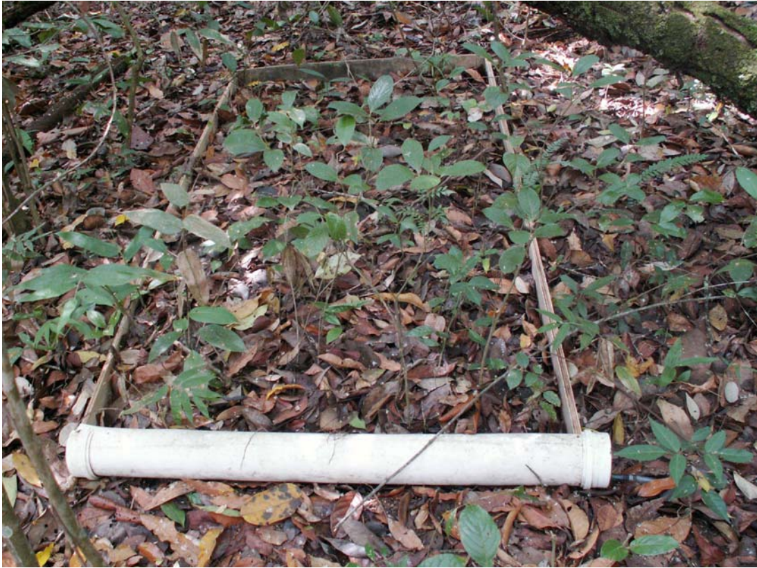
Figura 38 - Coletor de solução de escoamento superficial.
