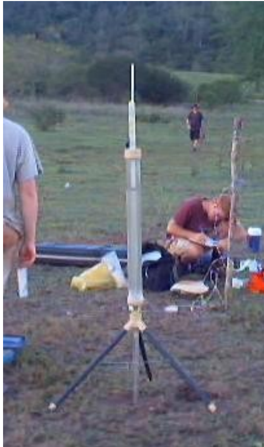
Figura 6- Permeômetro de Guelph, montado no campo.
