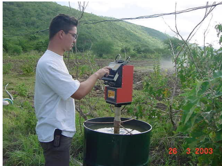
Figura 10- Leitura de umidade em reservatório de água para calibração.
