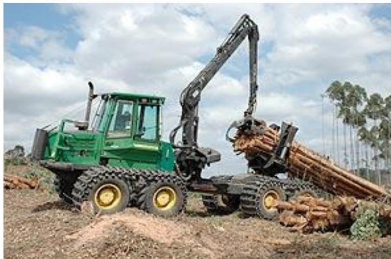
Figura 5. Skidder com garra e grua. (Fonte: John Deere)
