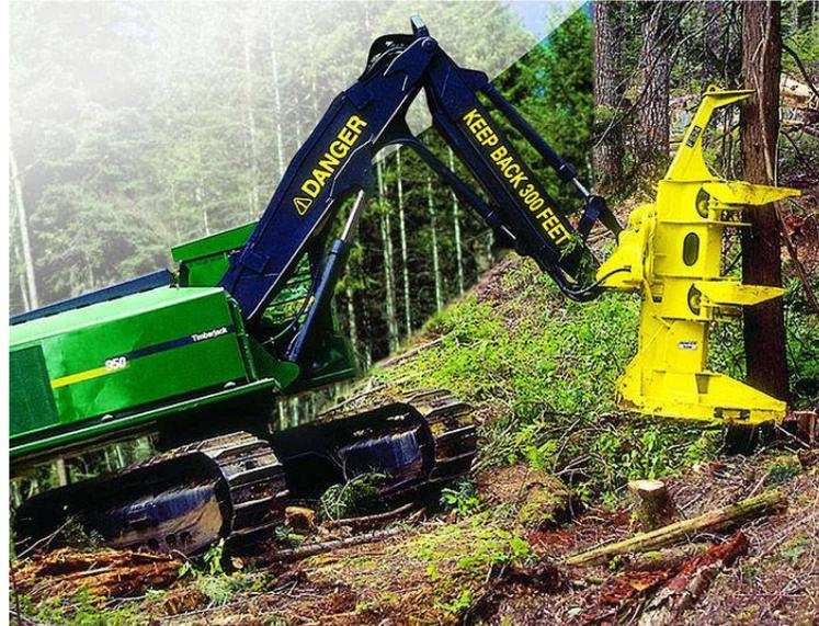
Figura 4. Feller Buncher. (Fonte: John Deere)
