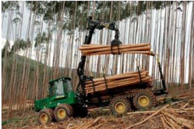
Figura 8. Forwarder autocarregável. (Fonte: John Deere)
