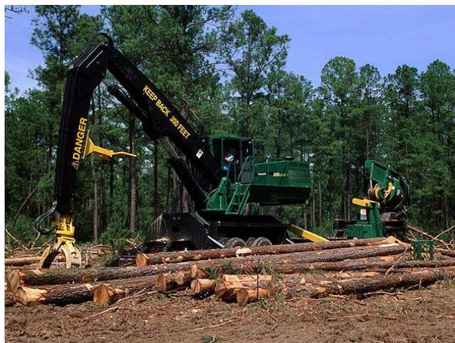
Figura 6. Garra traçadora. (Fonte: John Deere)
