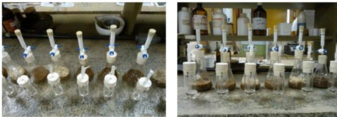
**Figura 10.** Detalhe dos respirômetros e da forma de disposição do resíduo.
