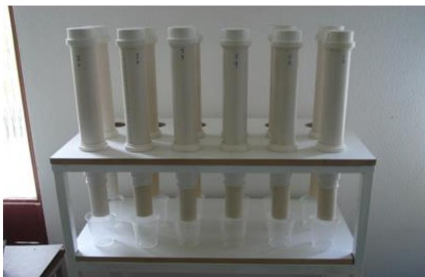
**Figura 9.** Detalhe dos tubos de PVC que acondicionavam as colunas de solo utilizadas para, por meio de lixiviações, se efetuar a quantificação da mineralização do nitrogênio, em laboratório.
