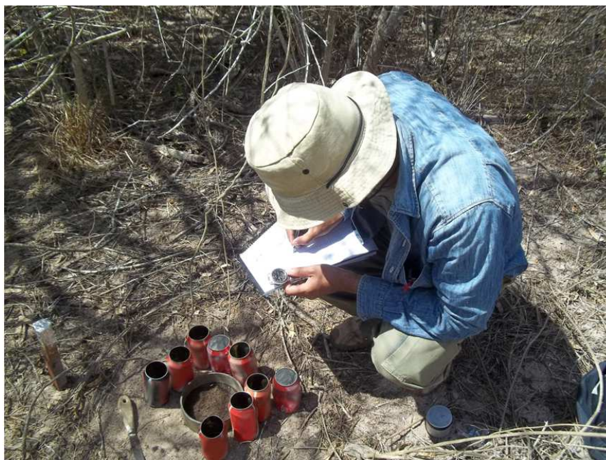
Figura 4. Procedimento do ensaio de infiltração
