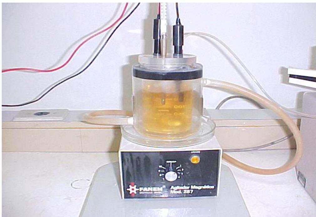
**Figura 10.** Reator utilizado para tratamento com plasma.
