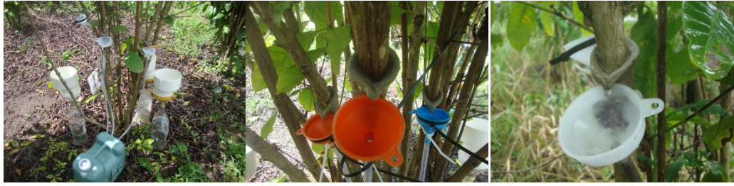
Figura 7. Sistema para coletar escoamento pelo tronco na cultura do café.
