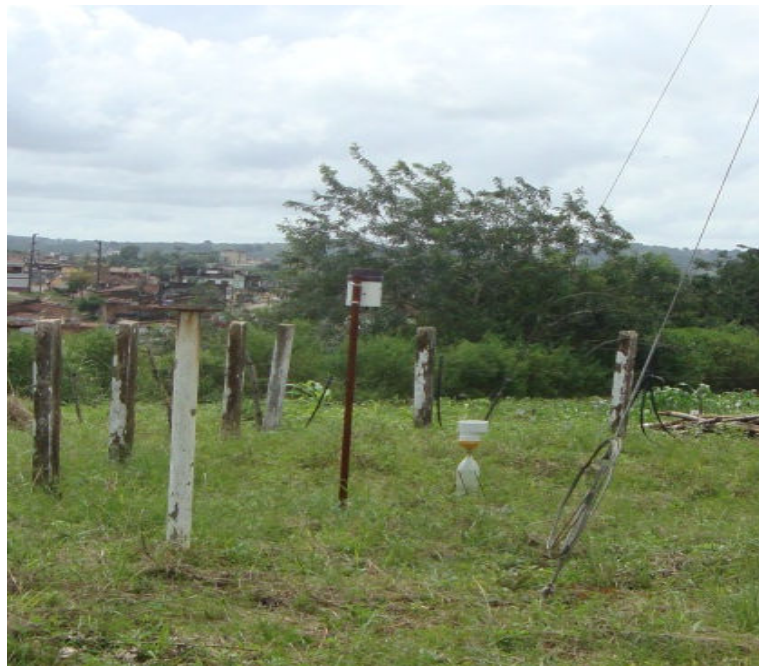
Figura 5. Pluviômetros utilizados para medir a precipitação total
