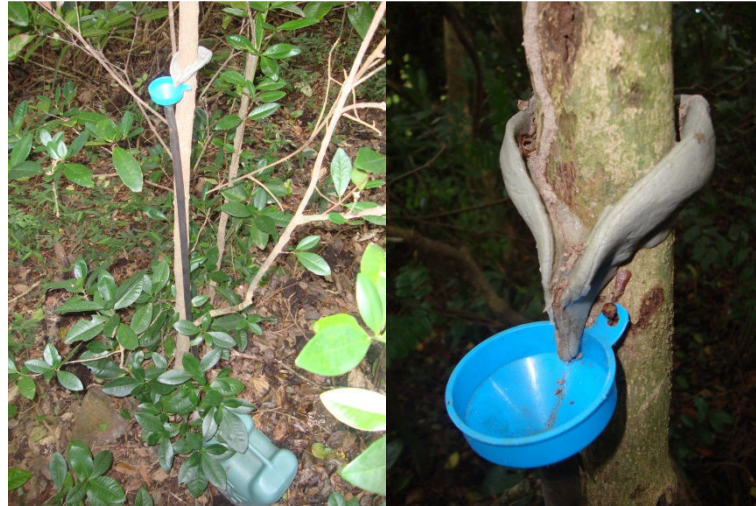
Figura 12. Sistema de captação de escoamento pelo tronco no sub-bosque
