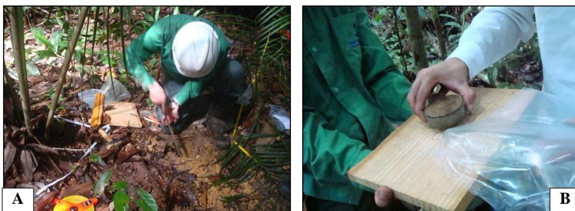
**FIGURA 6.** Coleta de amostra de solo em ponto de amostragem pelo método do anel volumétrico. A) Inserção do anel volumétrico no solo na camada de 30 a 50 cm. B) Anel volumétrico retirado com a amostra solo, na Mil Madeiras Preciosas, Silves, AM.
