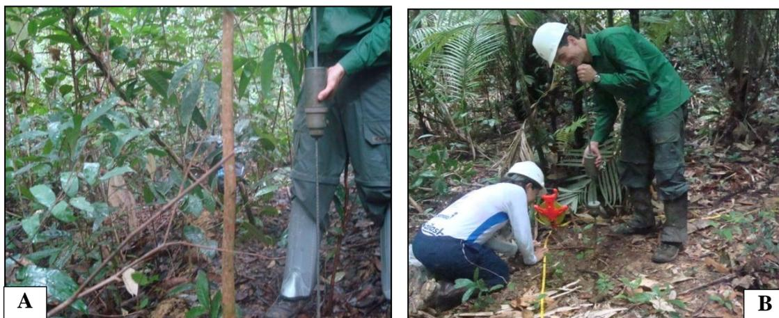
**FIGURA 7.** Coleta de dados de resistência do solo a penetração (RP). A) Penetrômetro de impacto utilizado para medição da RP. B) Processo de contagem dos golpes do penetrômetro de acordo com a profundidade, na Mil Madeiras Preciosas, Silves, AM.
