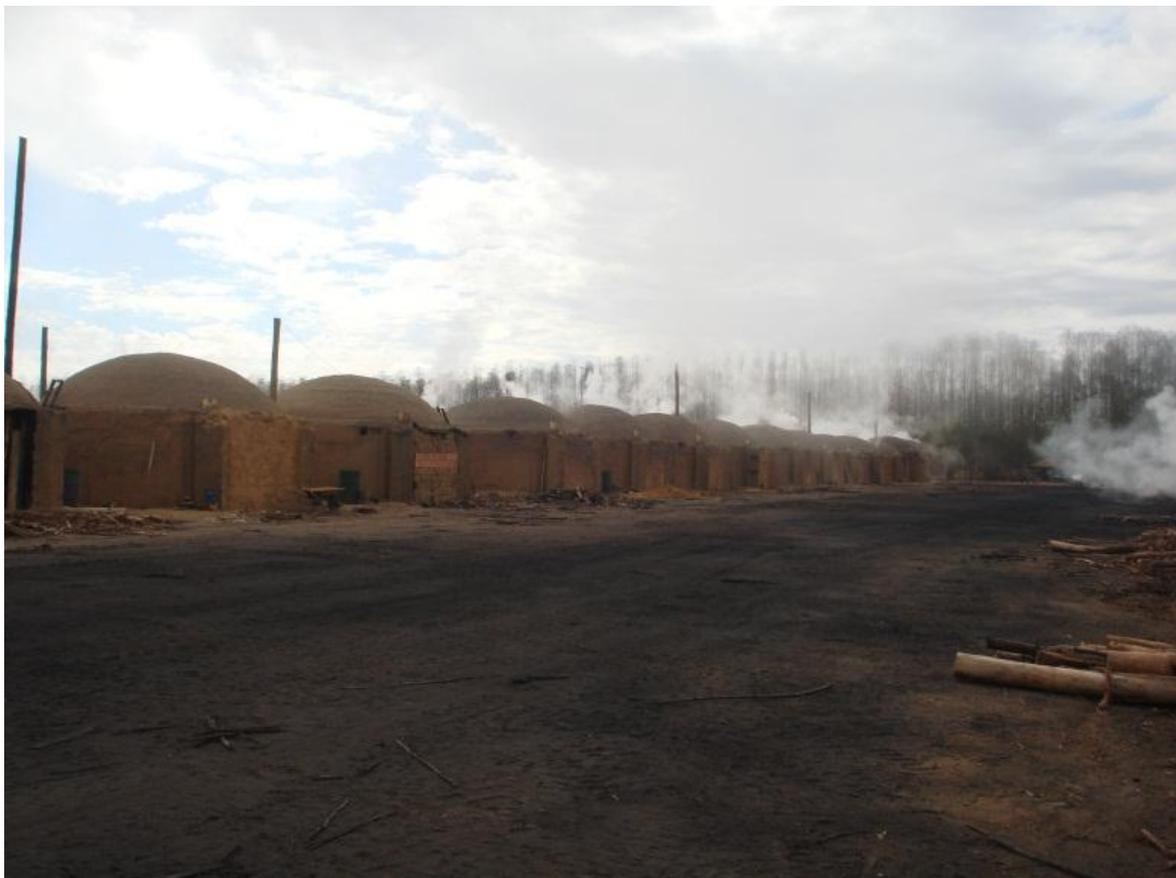
**Figura 3.4** - Fornos cilíndricos parabólicos, modelo JG, em operação no interior da empresa.
