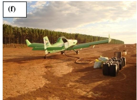
**Figura 3.2** - Processo de silvicultura: (a) combate a formigas; (b) gradagem; (c) trator com implemento subsolador; (d) plantio de muda; (e) irrigação da área plantada com o uso de trator e implemento de irrigação; (f) avião monomotor adaptado para lançamento aéreo de herbicida.
