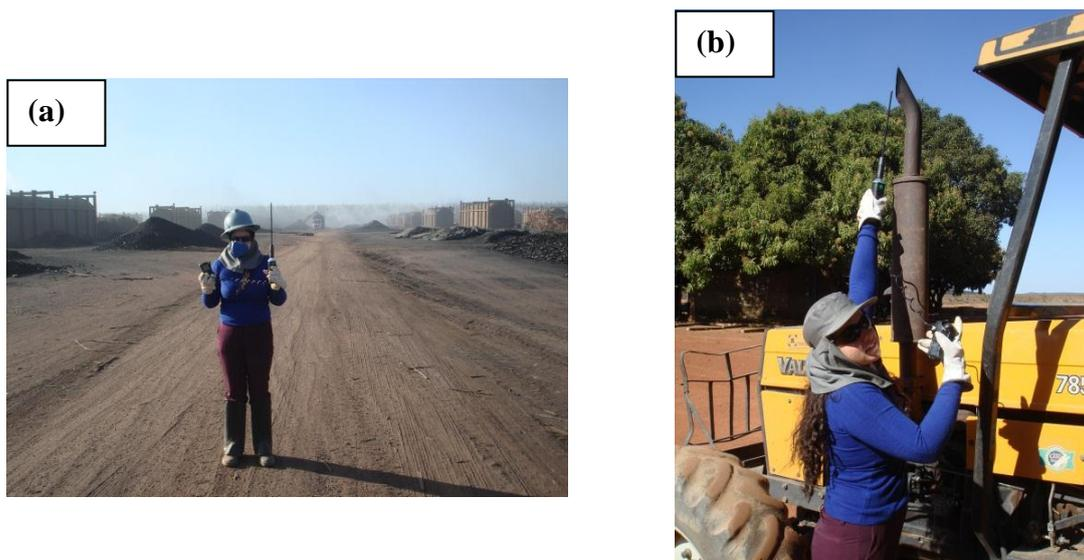
**Figura 3.7** - Utilização do multidetector de gás: (a) na UPC; (b) no escapamento de um trator.
