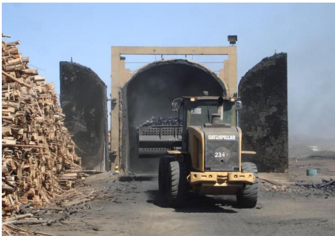
**Figura 3.6** - Descarga de fornos retangulares na UPC modelo RAC 220.
