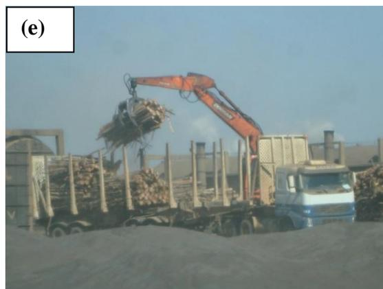
**Figura 3.3** - Processo de colheita: (a) *feller buncher* colhendo árvores; (b) *skidder* organizando as árvores derrubadas; (c) garra traçadora para beneficiamento de toras; (d) garra carregando caminhões; (e) garra descarregando caminhões na UPC.
