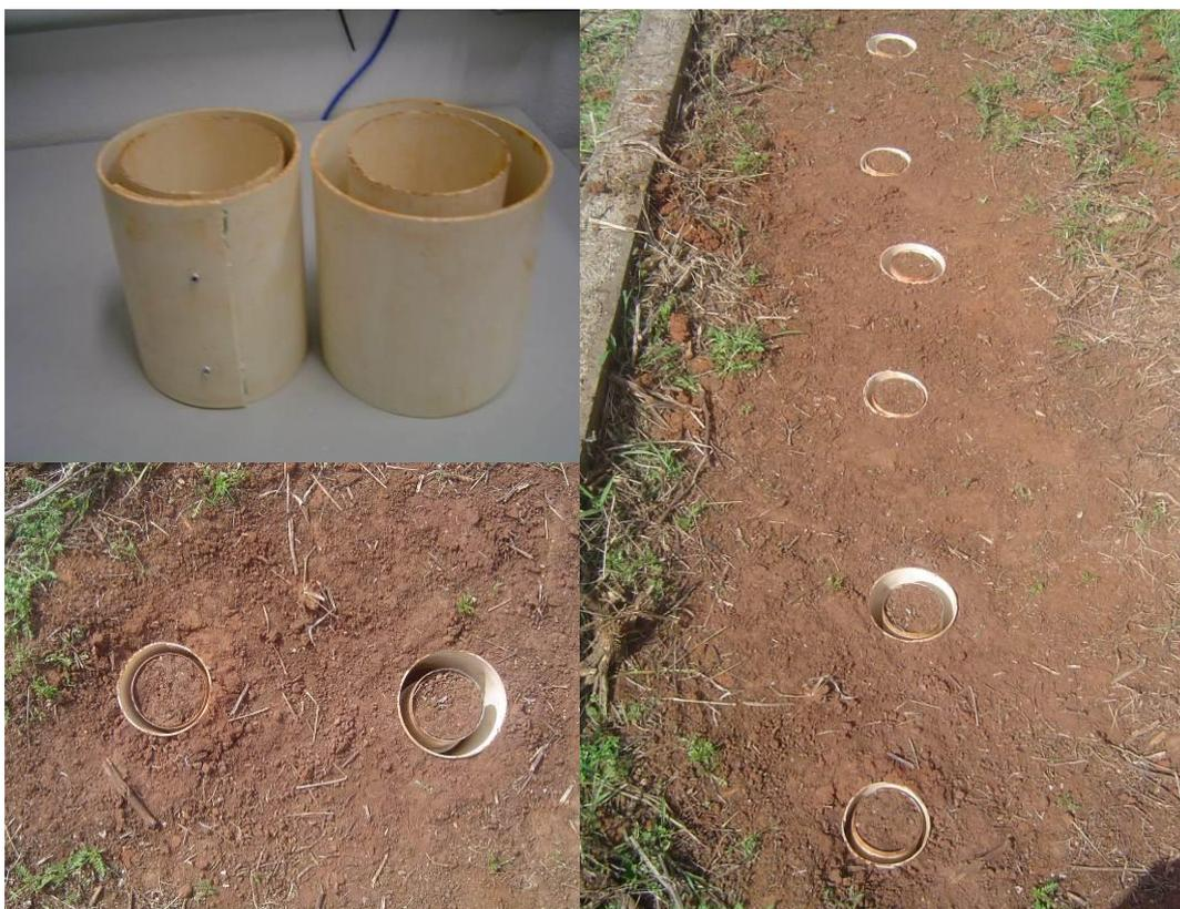
Figura 8 – Ensaio extra do microlisímetro comparando dois diferentes diâmetros de envoltório externo
