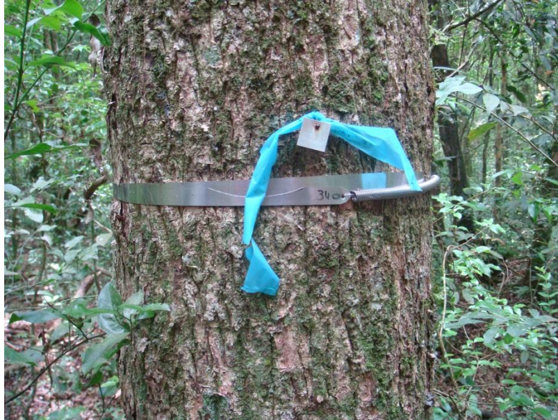
FIGURA 5 – DETALHE DA CINTA DENDROMÉTRICA PERMANENTE, EM AÇO INOXIDÁVEL, COM PRECISÃO DE 0,2 mm FONTE: O autor (2010)
