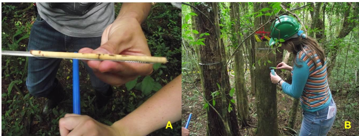
FIGURA 21 – COLETA DE AMOSTRAS RADIAIS DO LENHO. A: DETALHE DA AMOSTRA COLETADA COM TRADO DE PRESSLER. B: APLICAÇÃO DE SULFATO DE COBRE E CÁLCIO
