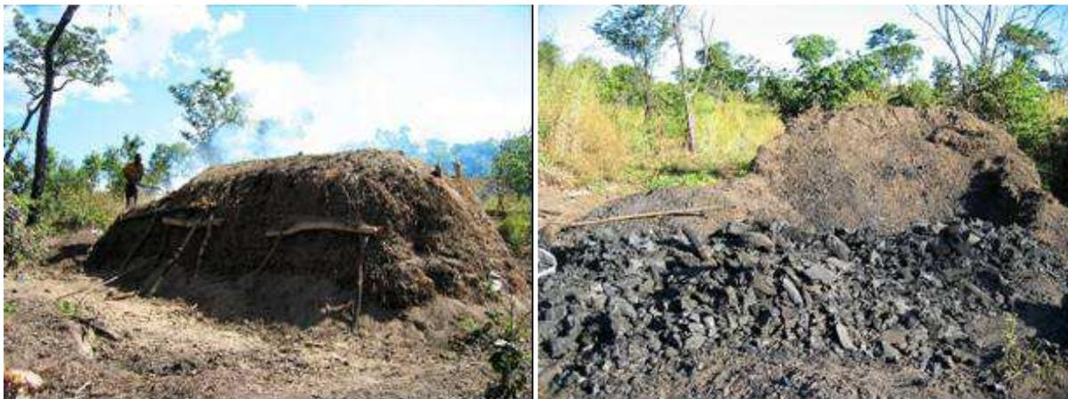
FIGURA 4: PROCESSO DE PRODUÇÃO DE CARVÃO VEGETAL EM FORNO TRADICIONAL DO TIPO CUPIM
