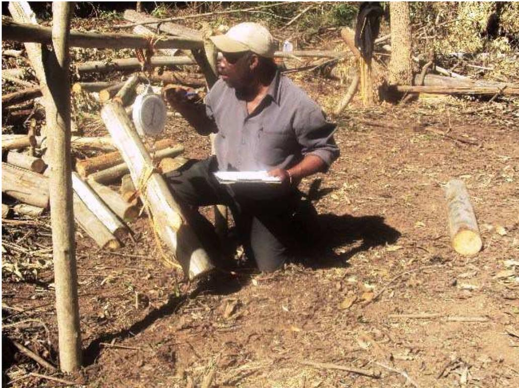
FIGURA 12: PESAGEM DE TORETES DE MADEIRA PARA CARBONIZAÇÃO EM MOÇAMBIQUE
