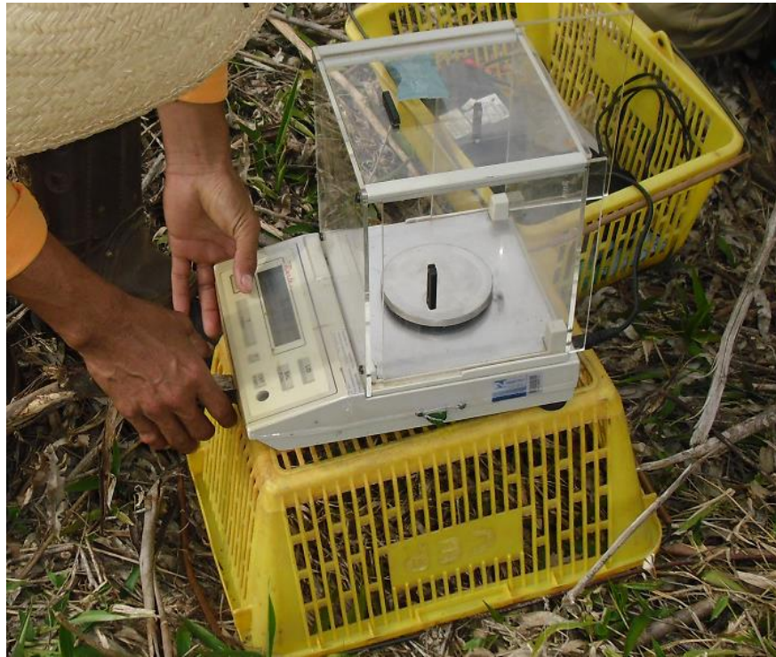
FIGURA 6 - BALANÇA DE PRECISÃO USADA PARA MEDIÇÃO DAS ISCAS PARCIALMENTE CONSUMIDAS
