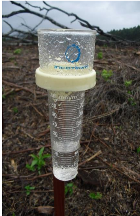
FIGURA 7- PLUVIÔMETRO INSTALADO À CAMPO FONTE: A autora (2012)
