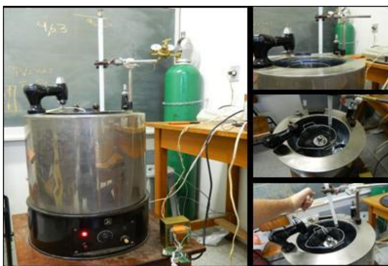
Figura 4 - Calorímetro equipamento utilizado para determinação do poder calorífico superior
