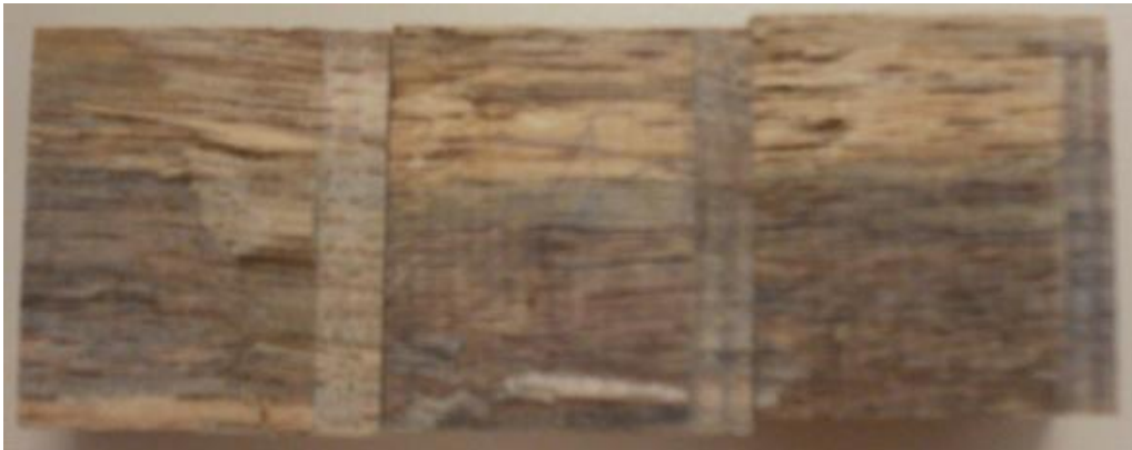
Figura 46 - Características das falhas observadas depois da ruptura ao cisalhamento dos corpos de prova das três espécies colados com o adesivo de mamona sintetizado co NCO/OH=2.2
