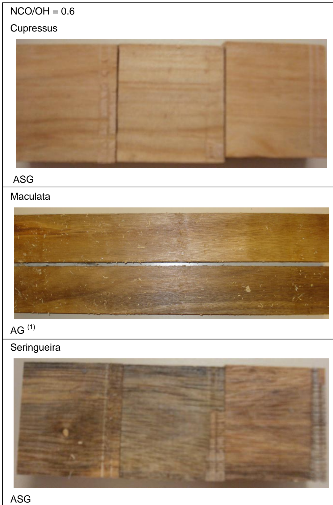
Figura 42 - Características das falhas observadas depois da ruptura ao cisalhamento dos corpos de prova das três espécies colados com o adesivo de mamona sintetizado co NCO/OH=0.6
