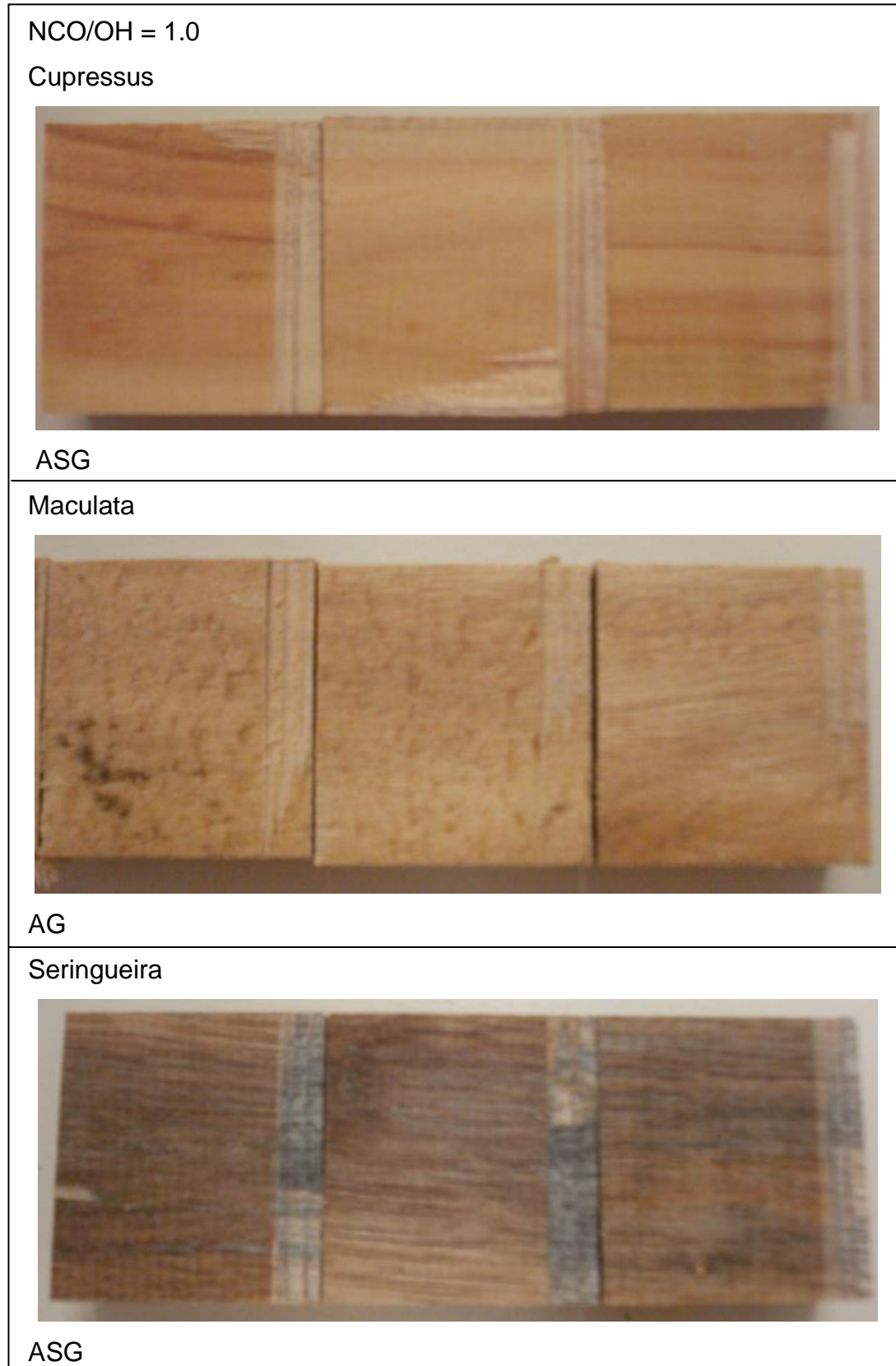
Figura 43 - Características das falhas observadas depois da ruptura ao cisalhamento dos corpos de prova das três espécies colados com o adesivo de mamona sintetizado co NCO/OH=1.0
