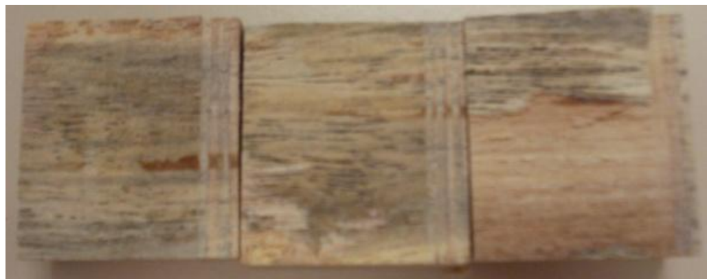
Figura 45 - Características das falhas observadas depois da ruptura ao cisalhamento dos corpos de prova das três espécies colados com o adesivo de mamona sintetizado co NCO/OH=1.8
