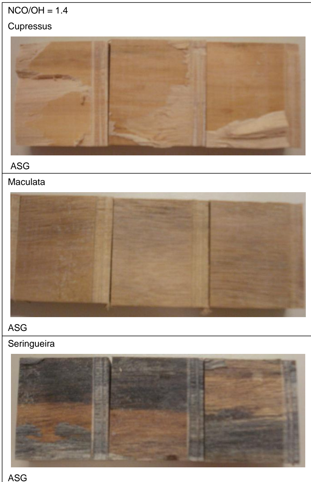
Figura 44 - Características das falhas observadas depois da ruptura ao cisalhamento dos corpos de prova das três espécies colados com o adesivo de mamona sintetizado co NCO/OH=1.4
