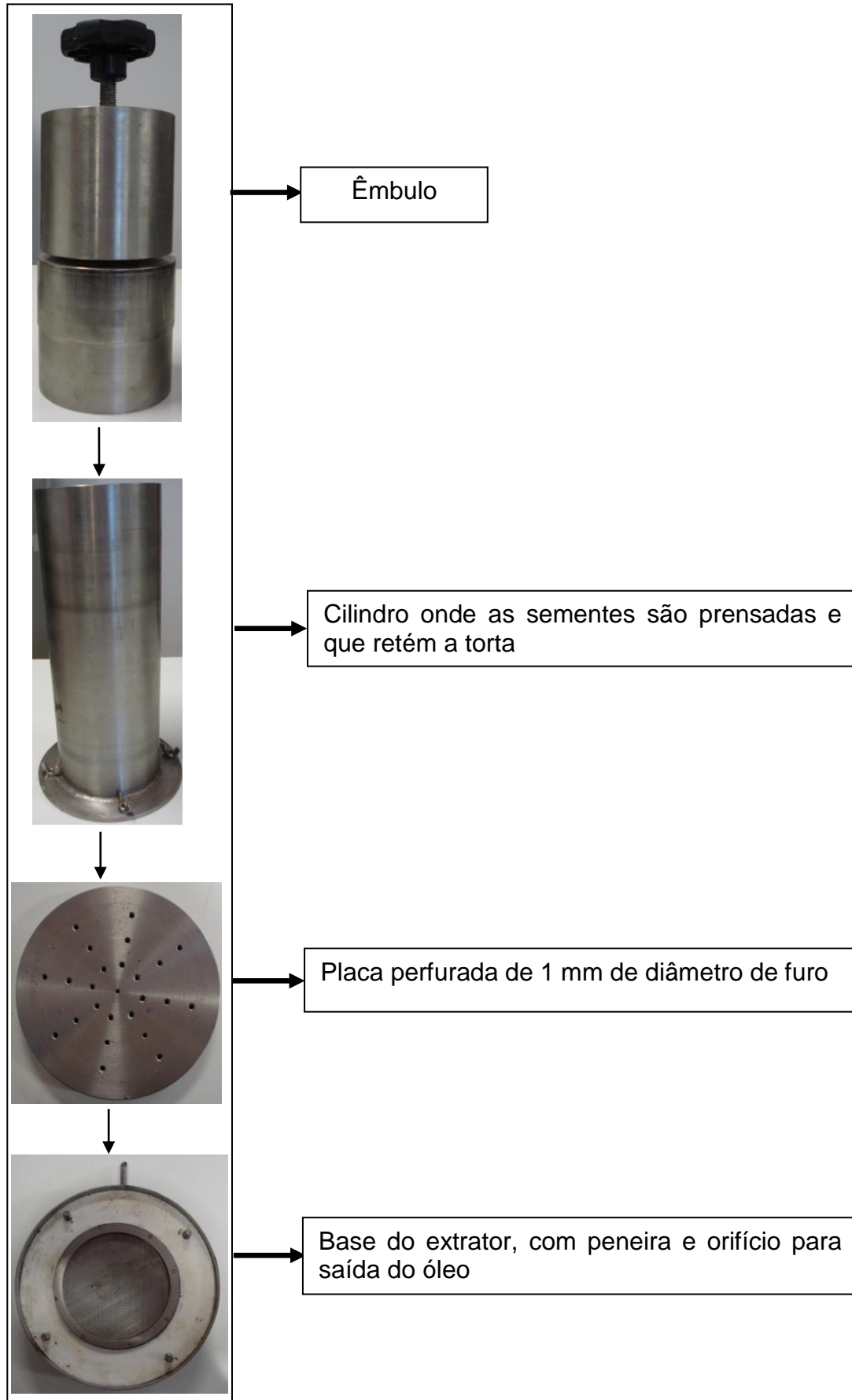
Figura 22 - Componentes do extrator de óleo de mamona
