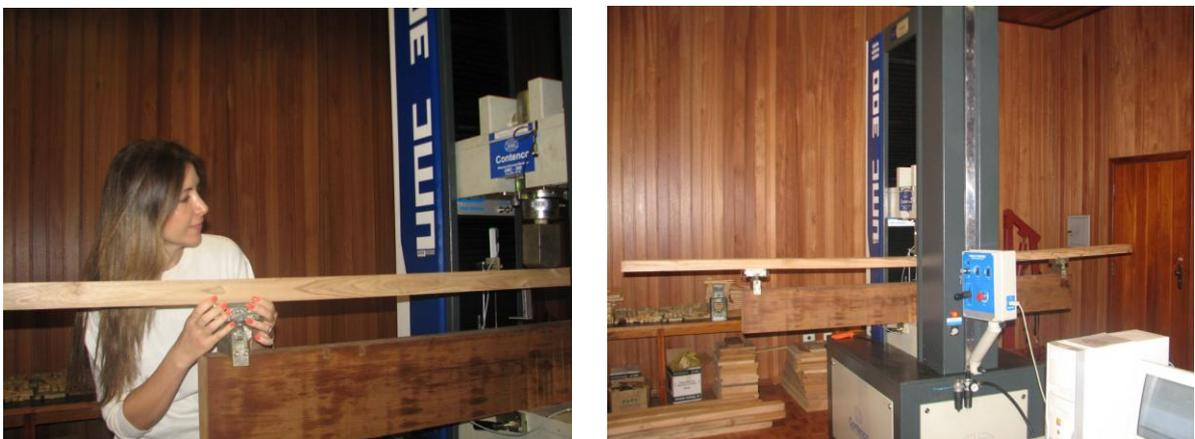
Figura 42- Ajuste da viga na máquina universal de ensaio
