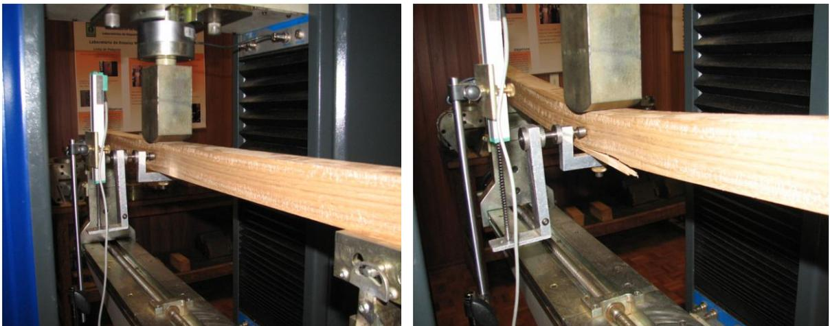
Figura 45 – Ensaio de flexão para a obtenção do  $E_{M0}$  com corpos de prova da NBR 7190/97
