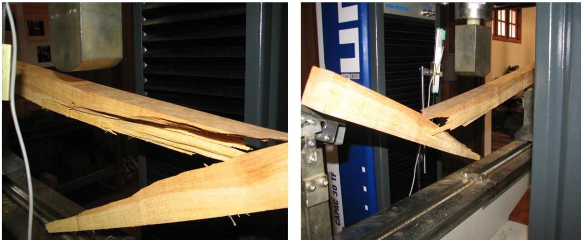
Figura 54 - Corpo de prova da Leucena com ruptura provocada por desvio de grã
