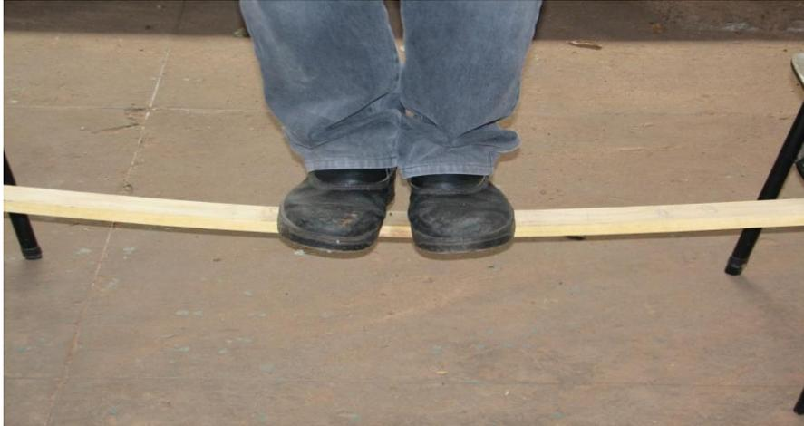
Figura 21 - Ensaio de flexão para a obtenção do módulo de ruptura
