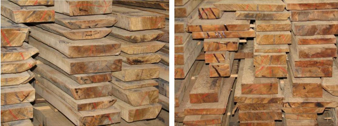
Figura 12 - Tábuas e pranchas empilhadas para secagem lenta
