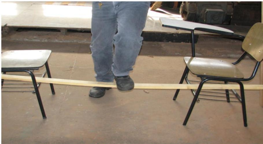
Figura 20 - Aplicação da carga para o ensaio de flexão
