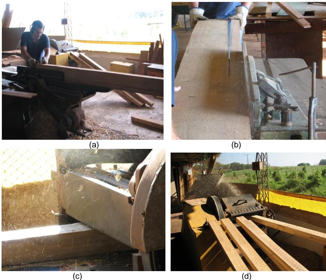
Figura 14 - Processamento das tábuas. Desempenadeira (a); serra circular (b) e desgrossadeira (c e d)
