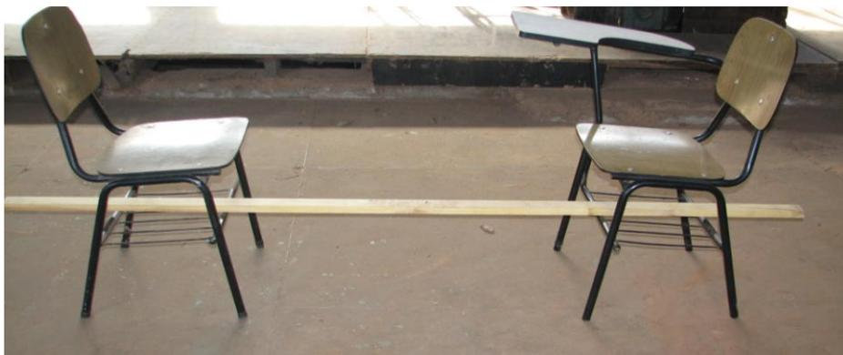
Figura 19 - Sarrafos apoiados em cadeiras para o ensaio de flexão
