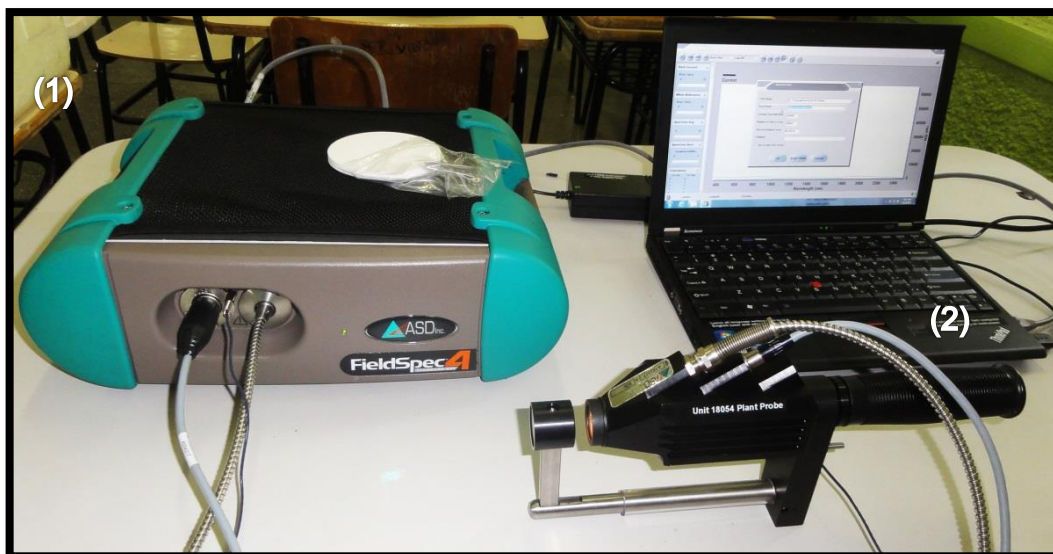
Figura 10 - (1) Espectrorradiômetro Fieldspec 4 Standard-RES e (2) Acessório Leaf Clip. Fonte: Analytical Spectral Devices – ASD .
