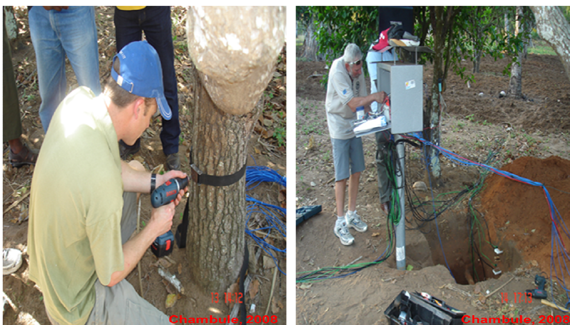
FIGURA 5. INSTALAÇÃO DO SISTEMA DE VELOCIDADE DE PULSO DE CALOR (HPV SIGLA INGLESA), A ESQUERDA ABERTURA DE FUROS NO ABACATEIRO E A DIREITA CONEXÃO DOS SENSORES NO DATA LOGGER CR1000.
