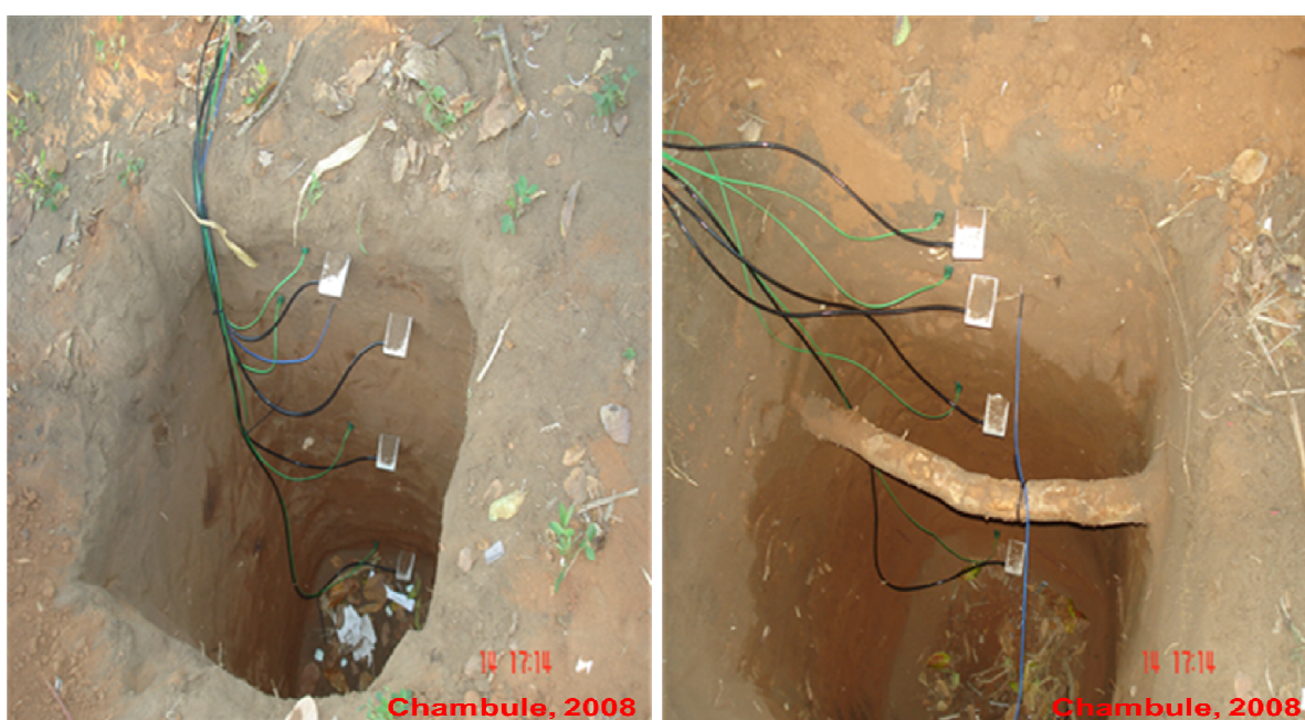
FIGURA 7. DISPOSIÇÃO DOS SENSORES DE UMIDADE NO SOLO SEM COMPONENTE ARBÓREO (À ESQUERDA) E COM COMPONENTE ARBÓREO (À DIREITA).
