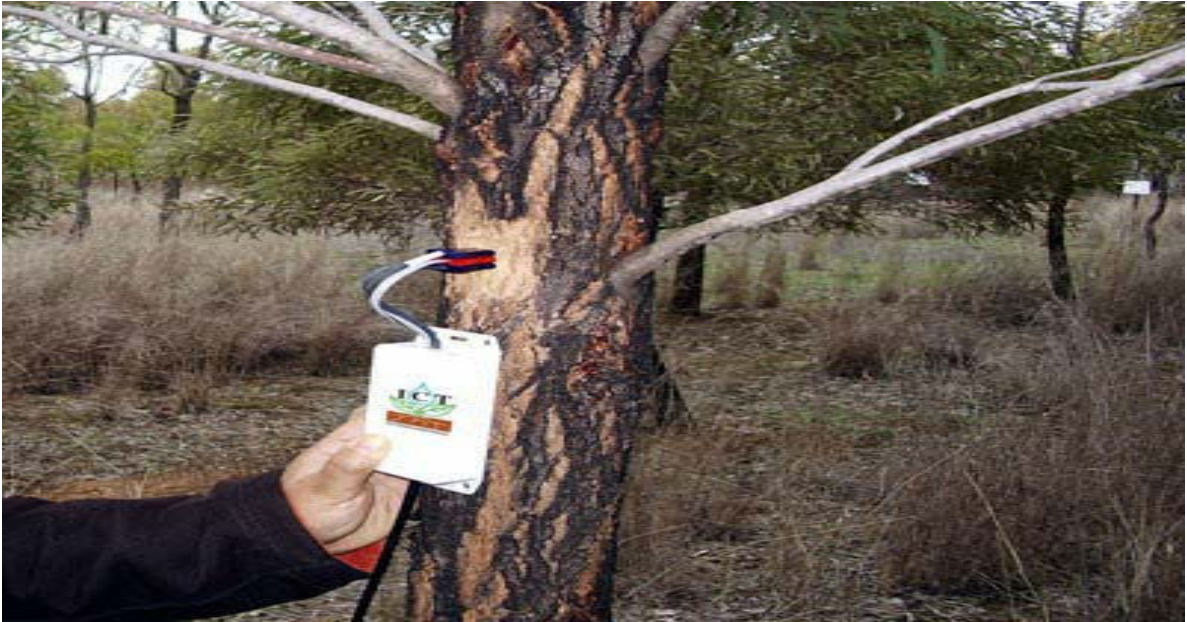
ANEXO 5. SENSORES MÉTODO DE RAZAO DE CALOR (HRM sigla Inglesa) Fonte: ICT, 2012
