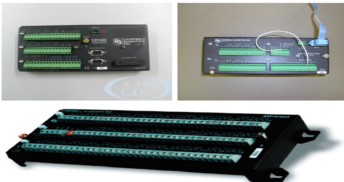
FIGURA 4. DATA LOGGER CR1000 (EM CIMA À ESQUERDA), DATA LOGGER CR10X (EM CIMA À DIREITA) E O MULTIPLEXER AM 16/32 (EM BAIXO).
