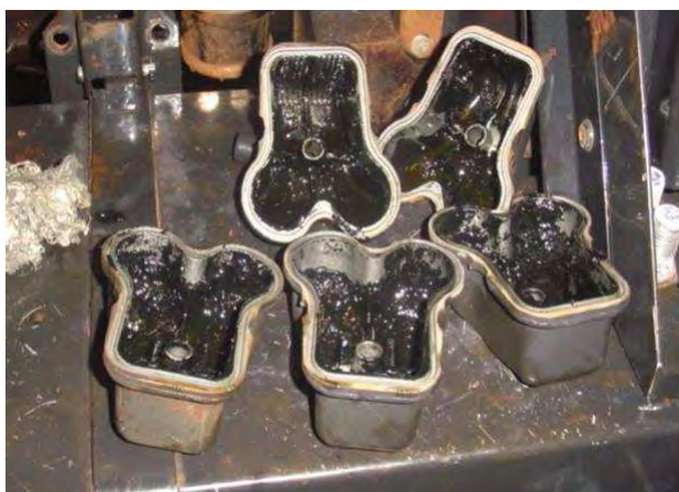
Figura 19 – Tampas de válvula de um motor MWM 6 cilindros apresentando resíduos, com 600 horas de utilização de 80% de óleo de soja bruto em Itumbiara/GO. (Valtra do Brasil).
