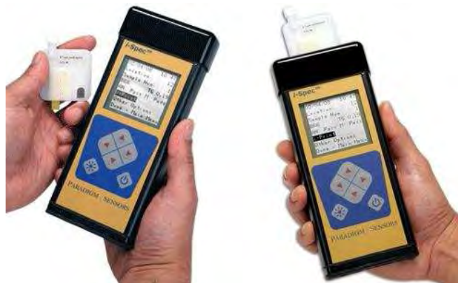
Figura 18 – Sensor portátil i-SPEC™ Q-100 da Paradigm - mede índices de glicerina total, metanol, acidez e percentagem da mistura diesel/biodiesel (Paradigmsensors, 2009).
