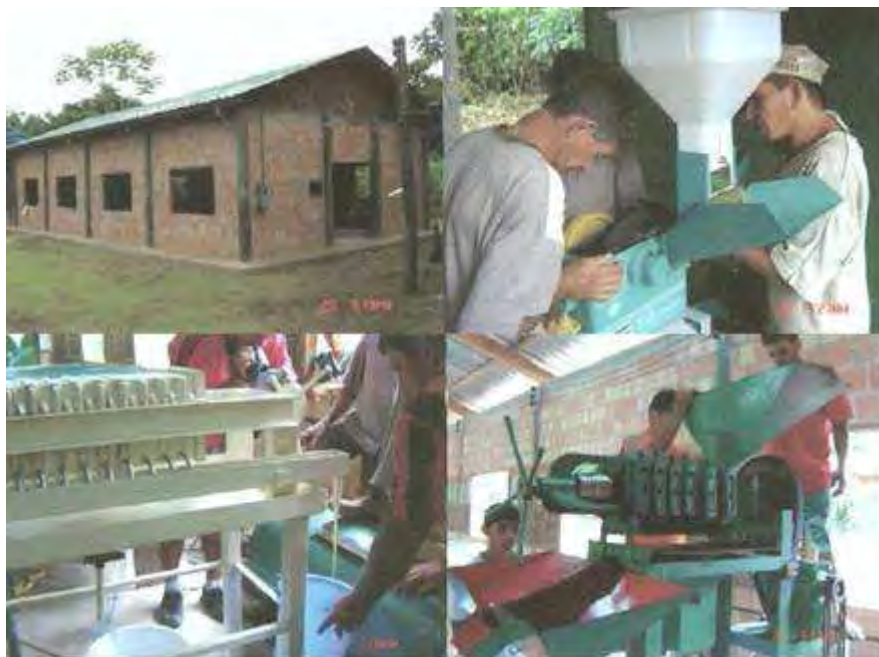
Figura 27 – Em sentido horário, Galpão da Usina Castanha-de-Cotia, triturador de sementes, prensa mecânica, e filtro de pano com produção do óleo filtrado. (MME, 2005).
