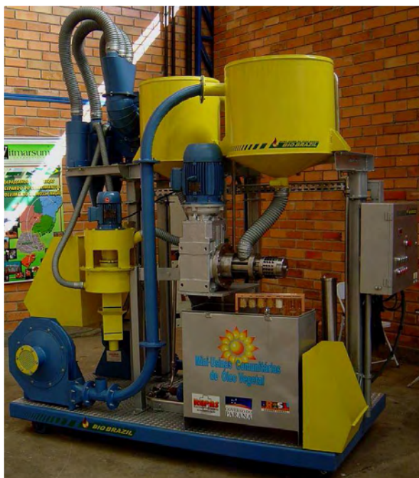
Figura 34 – Modelo de Mini-usina compacta de extração de óleo vegetal a frio da BIOBRAZIL (ICD; REPAS; TECPAR, 2007).
