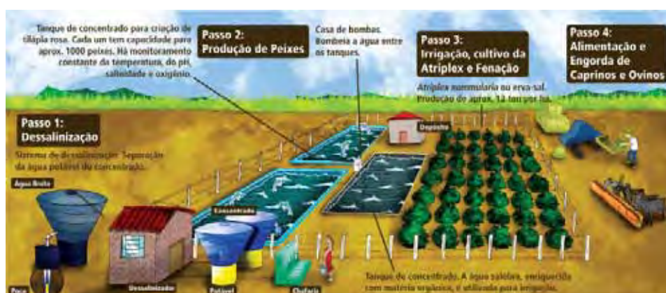
Figura 10 Desenho esquemático do sistema de produção integrado do Programa Água Doce
