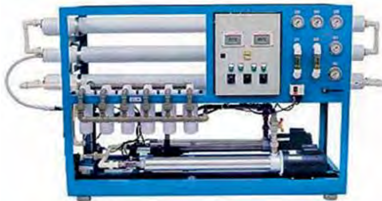
Figura 27 Fotografia de um dessalinizador de 9 membranas
