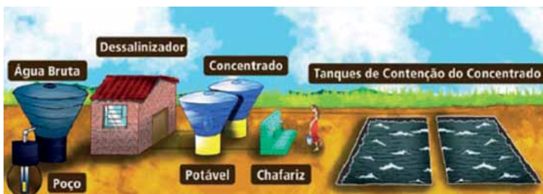
Figura 26 Sistema de dessalinização adotado pelo Programa Água Doce
